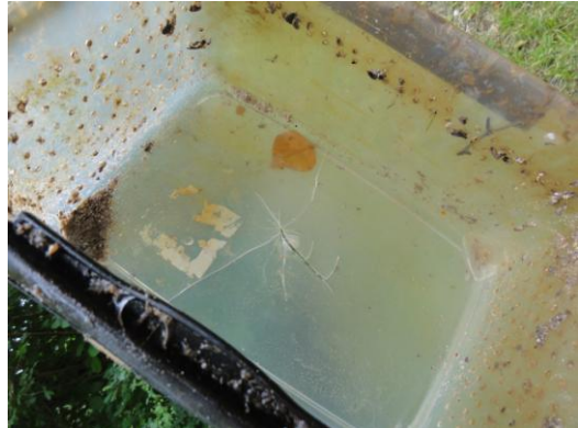
Abb. 13: Ursprünglich verwendeter, defekter Käfig für die Bachmuscheln. Der Kunststoff des an sich sehr stabilen Gehäuses wurde im Verlauf der Exposition brüchig.
